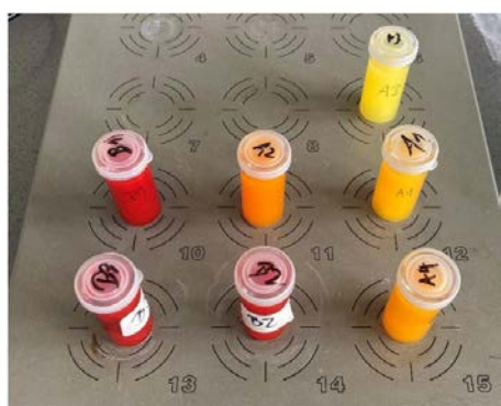
Abb. 2: Vermischen von Farbstofflösung und CAU-55-SO 4 Pulver mit einer Rührplatte.
