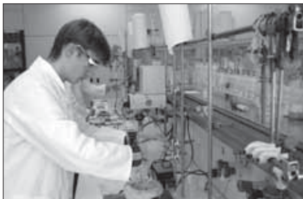
Im Ausbildungslabor der Firma Wacker wurde Benzoesäure aus Benzaldehyd in einer Cannizzaro-Reaktion hergestellt.
